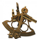
Le sextant Pour mesurer la hauteur d'un astre au-dessus de l'horizon
